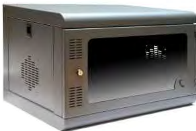
Armario Compaqrack mural 19" 1 cuerpo fondo 400mm 6U acceso por los laterales desmontables
